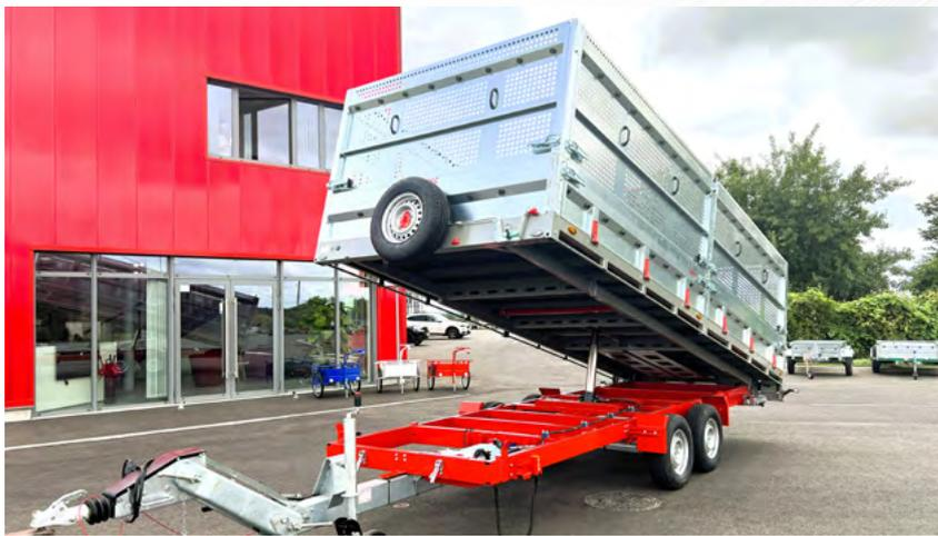
Timon articulé, rehausse, bennage électrique... (PB550x220)
