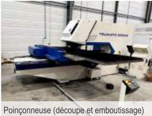
Poinçonneuse (découpe et emboutissage)
