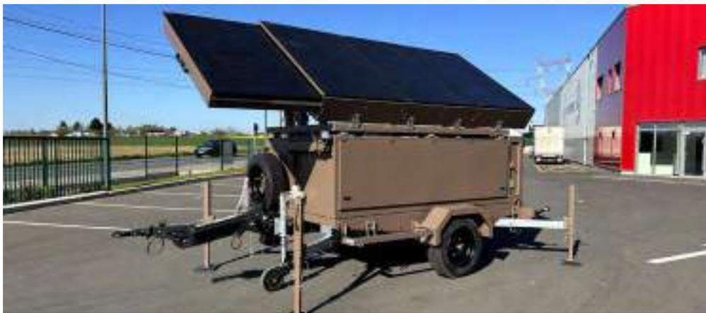
Système de charge autonome projetable
