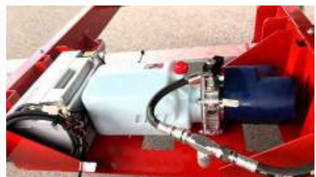
Centrale électrohydraulique avec batterie (Bennage)
