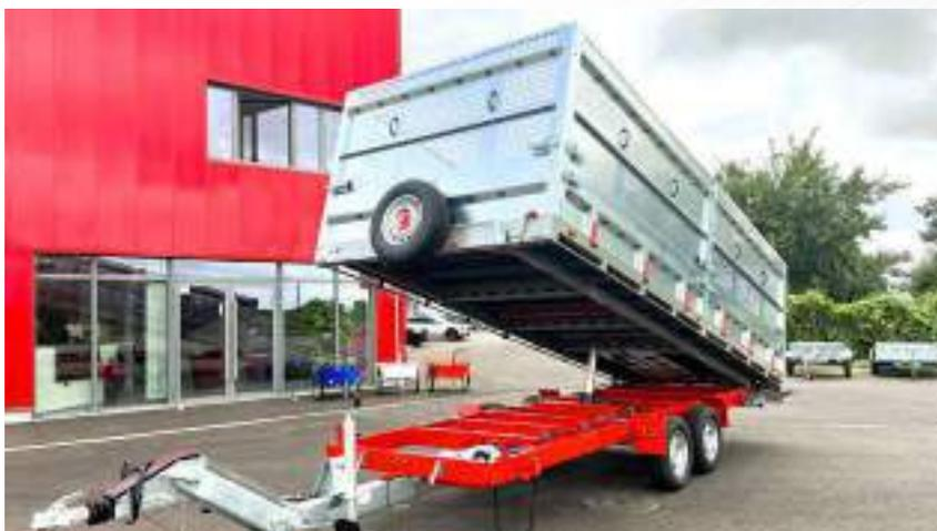
Timon articulé, rehausse, bennage électrique... (PB550x220)
