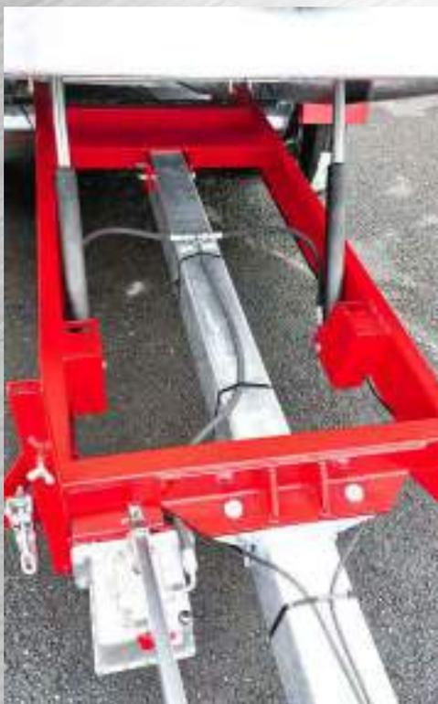
Timon articulé **basculant** hydraulique
