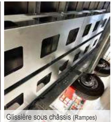
Glissière sous châssis (Rampes)
