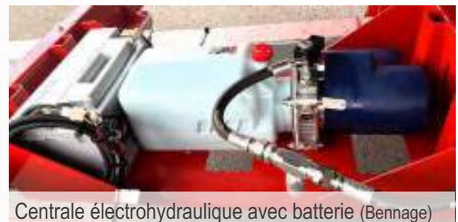
Centrale électrohydraulique avec batterie (Bennage)
