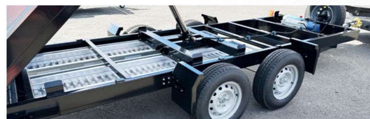
Bennage électrique, rampes avec glissières... (PB450x200)
