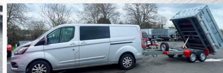
Bennage électrique, rehausse (PB250x180)
