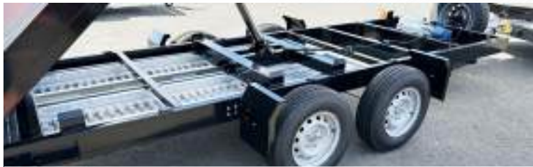
Bennage électrique, rampes avec glissières... (PB450x200)
