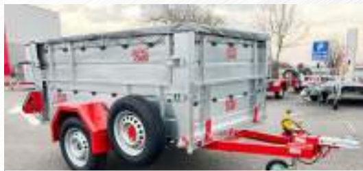
Rehausse, bâche plate, roue secours (S500)
