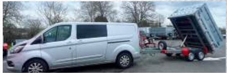
Bennage électrique, rehausse (PB250x180)
