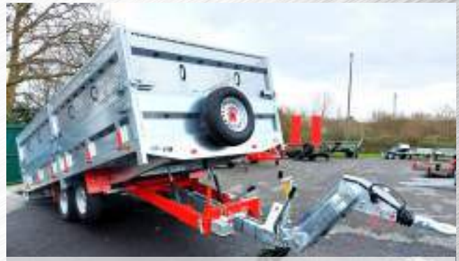
Timon articulé + basculant hyd , ridelles... (P500x200)
