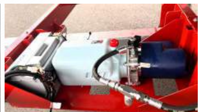
Centrale électrohydraulique avec batterie (Bennage)
