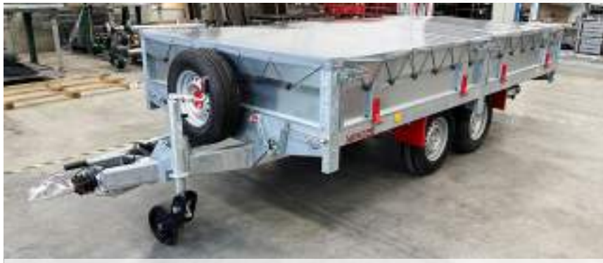
Full galva., ridelles, bâche plate & barre de soutien, rampe... (P400x200)
