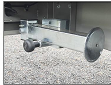
Béquillage arrière basculant
