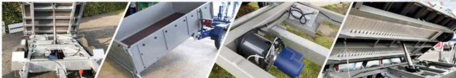
Bennage par pompe à main, caisse amovible, centrale électrohydraulique, rangement sous châssis...
