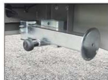
Béquillage arrière basculant
