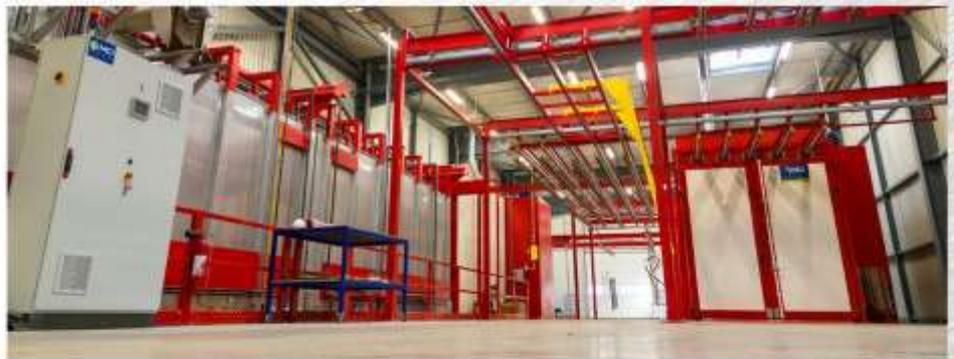
Nous disposons d'une chaîne de peinture thermolaquage d'une surface dépassant les 750m<sup>2</sup> pour la finition de vos remorques, mais aussi tout autres produits métallique capable de rentrer dans le four tel que portail, escalier, jantes, garde corps et bien d'autres.
