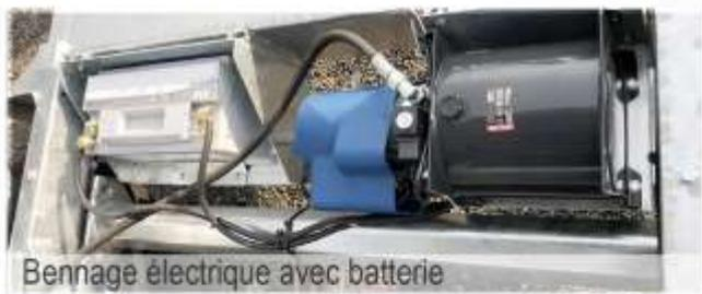
Bennage électrique avec batterie
