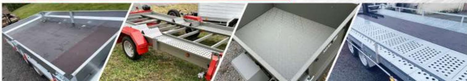
Plateforme de chargement : bois CP15mm, tôle galva./aluminium sur CP, tôle perforée (adhérence), mixte...
