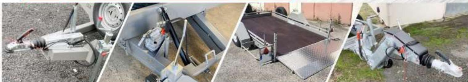
Attache à inertie, flèche basculante hydraulique, essieu abaissable, timon articulé (réglable en hauteur)...
