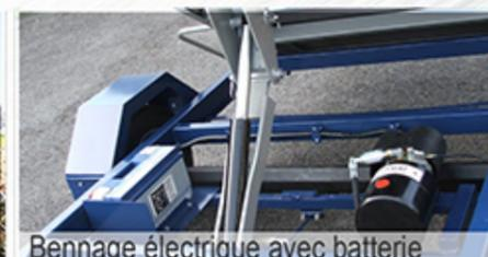
Bennage électrique avec batterie
