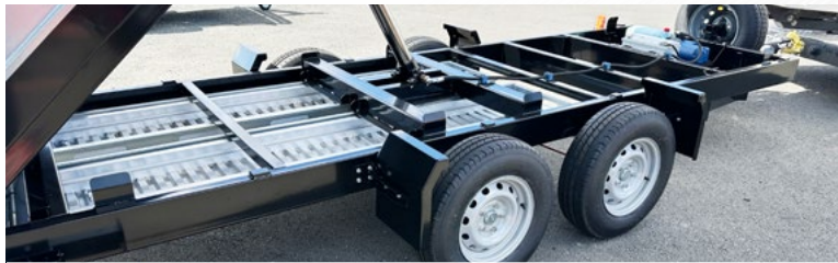
Bennage électrique, rampes avec glissières... (PB450x200)
