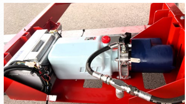
Centrale électrohydraulique avec batterie (Bannage)
